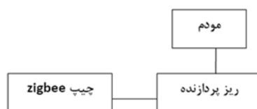
شکل ۲-۱۱- بلوک دیاگرام طراحی سخت افزار بخش نقاط مرکزی
