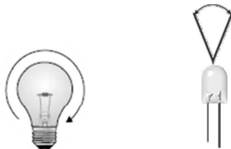
شکل ۳: مقایسه نحوه انتشار نور در LED و لامپ معمولی
