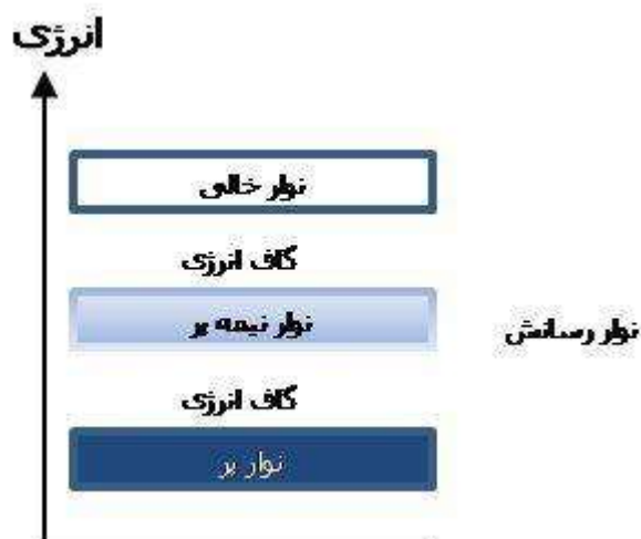
شکل ۱-۲: نحوه قرارگیری ترازها، نوارها و گاف انرژی در یک جسم رسانا
